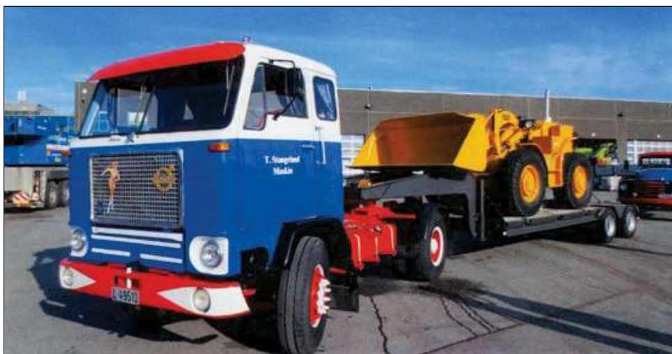
Over: Her en Volvo type L 495 Tip Top, en sjelden variant fra 1965. Volvo laget bare 953 stykker av denne modellen med to aksler. Flere eiere har tatt hver sin del av fornyelsen. Til sandblåsing gikk det med 1,6 tonn sand, så her lekte en ikke akkurat med småbiler.
